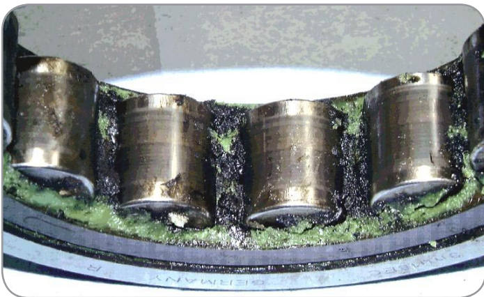
Деградация смазки по причине токов электрического разряда
